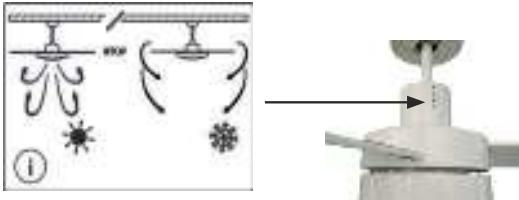
Temps froid – le ventilateur tourne dans le sens horaire. Une circulation d'air vers le haut déplace l'air chaud stagnant de la région du plafond. Ceci permet de régler le chauffage à une température plus faible sans diminution de niveau de confort.
