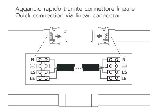
Quando si desidera utilizzare più di una plafoniera, sganciare il connettore all'estremità, quindi collegare il cavo di un'altra plafoniera al terminale di cablaggio attraverso il connettore. Rimontare il connettore.
