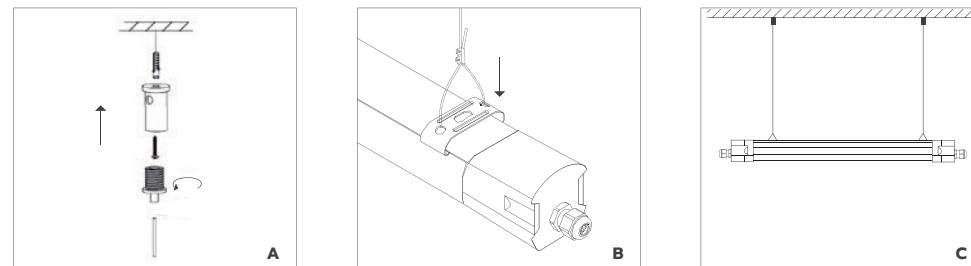
**A** - Fissare i fermacavi a soffitto
