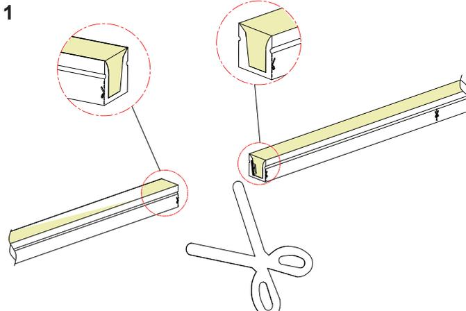
Schneiden Sie zum Kürzen des Stripes mit einer Schere / einem scharfen, stabilen Messer entlang der auf der Rückseite des LED-Streifen angebrachten Markierung. /
