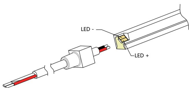
Richten Sie das Einspeisekabel entsprechend der Polarität des LED-Streifens aus. /
