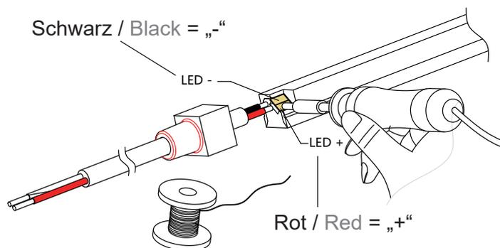
Löten sie die Adern-Enden des Einspeisekabels auf die entsprechenden Kontakte auf der Platine. Achten Sie dabei auf die richtige Polarität. /
