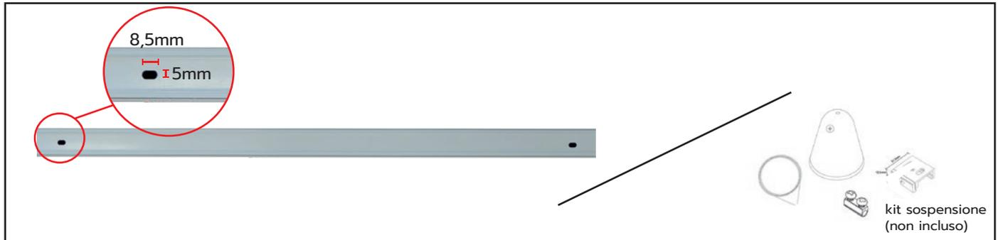
1- Montare a soffitto con le viti o con kit sospensione (accessorio a parte cod. ACBNRBI-KIT, ACBNRNE-KIT)
