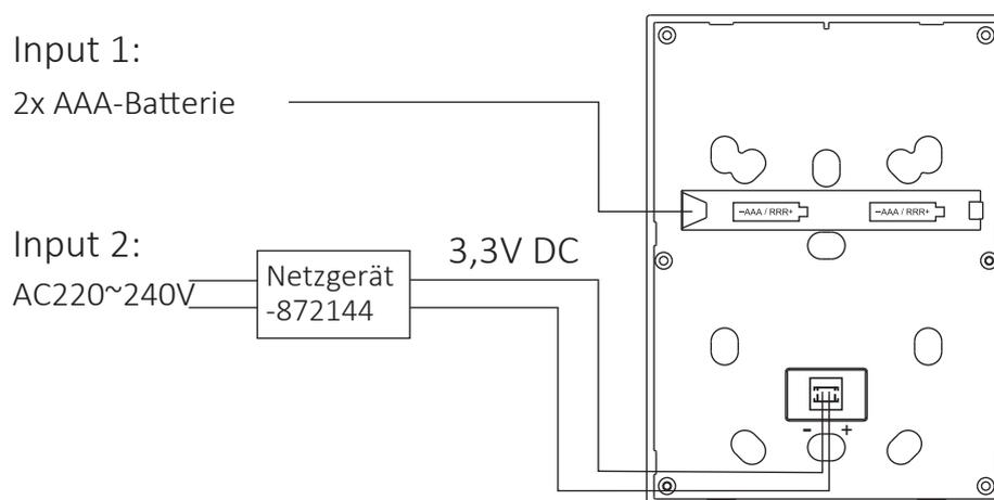
Verbinden Sie nun den sekundärseitigen Stecker des Netzgeräts mit dem dafür vorgesehenen Steckverbinder der Wandfernbedienung. /
