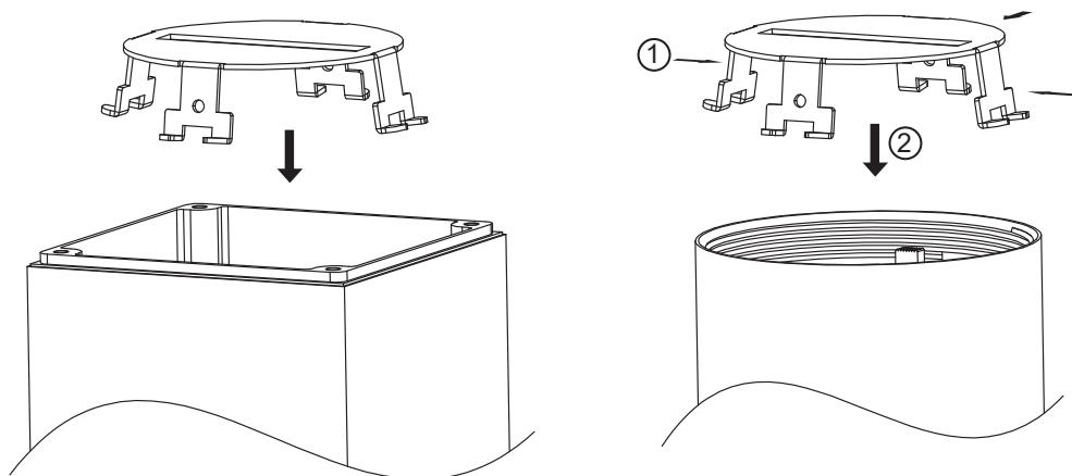
1. Füße des Blenden-Einsatzes leicht zusammendrücken, ohne diese zu verbiegen, um sie in den Leuchtenkörper einzusetzen. Die Füße müssen eine leichte Vorspannung aufweisen, um sicher und dauerhaft im Leuchtenkörper zu sitzen. /
