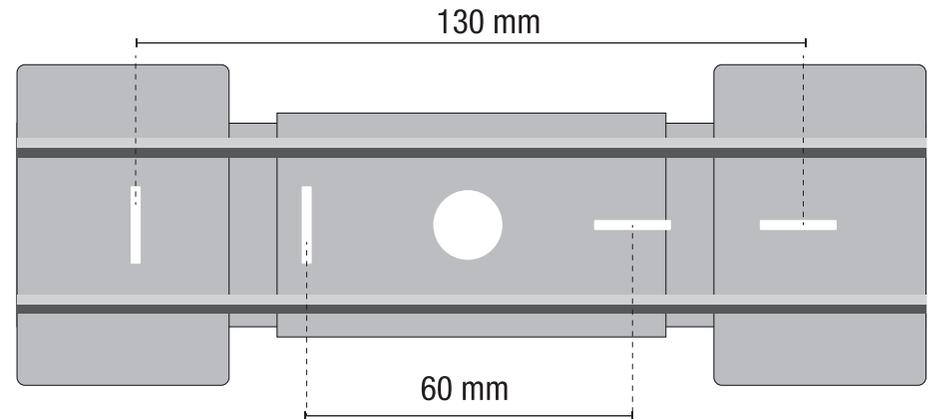
**IT** 1. Realizzare i fori nella parete secondo le distanze del supporto di montaggio del modello acquistato. - 2. Eseguire il collegamento elettrico - 3. Montare la plafoniera con il meccanismo a scatto.
