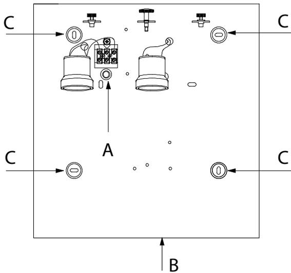
► Far passare i cavi elettrici provenienti dalla parete attraverso il foro A e fissare il fondello B alla parete mediante le aole C. Romuovere il coprimorsetto. Eseguire i collegamenti elettrici all'apposito morsetto collegando il cavo di messa a terra al polo contrassegnato con ⊕. Rimontare il coprimorsetto.
