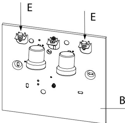
► Appoggiare il diffusore D sul fondello B e controllare la sua posizione. Nel caso fosse necessario regolare in orizzontale il suo orientamento, rimuoverlo dal fondello ed agire manualmente sulle due viti E, fino a raggiungere un corretto allineamento orizzontale. Eseguita questa operazione, inserire le lampadine. Posizionare il diffusore D sul fondello B ed avvitare la vite F.
