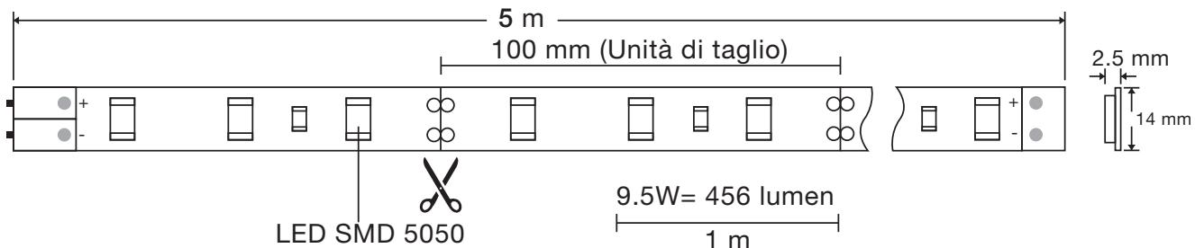
Indispensabile fissaggio su profili in alluminio per una adeguata dissipazione del calore. Da ordinare separatamente.
