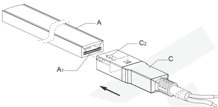
3. Führen Sie die PINs (C2) in die Unterseite der FPC-Platine am LED-Bandlicht (A1) ein, drücken Sie den Stecker (C) nach unten. Verbinden Sie das LED-Bandlicht mit dem Netzkabel (C3), um zu prüfen, ob das LED-Bandlicht (A) normal eingeschaltet werden kann. /
