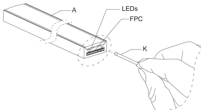
2. Setzen Sie mit einem Schlitzschraubendreher (K) die Unterseite der FPC-Platine ein und kippen Sie sie leicht nach oben /
