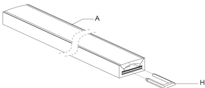
1. Stecken Sie den U-Typ-Stecker (H) in das LED-Bandlicht (A). Stellen Sie sicher, dass sich der U-Typ-Stecker (H) auf der oberen Fläche der FPC befindet /
