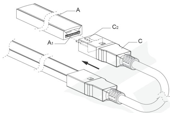
3. Führen Sie die PINs (C2) in die Unterseite der FPC-Platine am LED-Bandlicht (A1) ein, drücken Sie den Stecker (C) nach unten. Verbinden Sie das LED-Bandlicht mit dem Netzkabel (C3), um zu prüfen, ob das LED-Bandlicht (A) normal eingeschaltet werden kann. /
