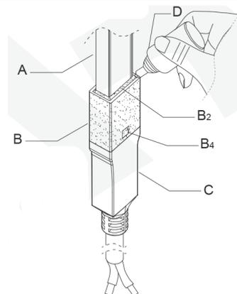
4. Stellen Sie nach dem erfolgreichen Einschalten das LED-Tapelight (A) vertikal auf und halten Sie es still, füllen Sie die Lücke von (B2) mit Kleber (D). (Achtung: Bitte wischen Sie den überschüssigen Kleber mit einem Lappen ab).
