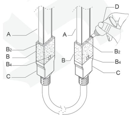
4. Stellen Sie nach dem erfolgreichen Einschalten das LED-Tapelicht (A) vertikal auf und halten Sie es still, füllen Sie die Lücke von (B2) mit Kleber (D). (Achtung: Bitte wischen Sie den überschüssigen Kleber mit einem Lappen ab).
