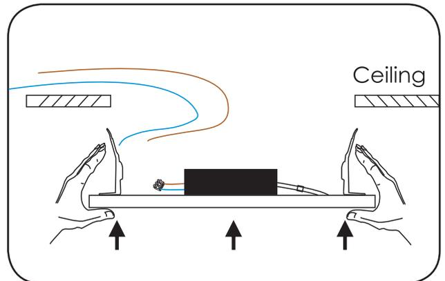
**IT** Collegare il LED Driver a corrente alternata di rete. Spingere il Pannello nella cavità del soffitto con le molle in rilievo.
