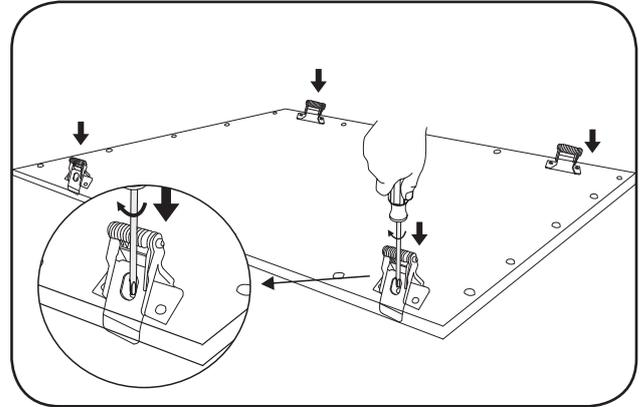
**IT** Posizionare le molle in posizione e reinstallare le quattro viti. (Le viti devono essere inserite attraverso il foro centrale della clip come sopra illustrato).
