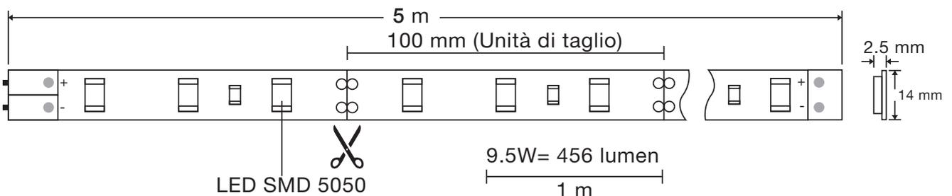
Indispensabile fissaggio su profili in alluminio per una adeguata dissipazione del calore. Da ordinare separatamente.
