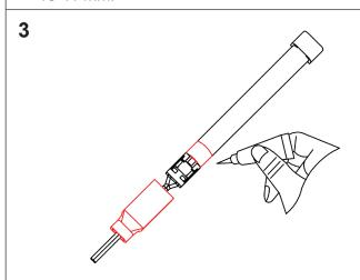
Tragen Sie das Silikon auf die Endkappe auf und schieben Sie diese über das Ende des Lichtstreifens. Wischen Sie das überschüssige Silikon mit einem staubfreien Tuch ab. Apply the silicone to the end cap and slide it over the end of the light strip. Wipe off the excess silicone with a dust-free cloth.
