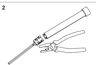
Stecken Sie die freiliegende flexiblen Leiterplatte in den Steckverbinder und klemmen Sie die Steckverbinder-PINs mit einer Zange, um den Kontakt zur flexiblen Leiterplatte herzustellen. Insert the exposed flexible printed circuit board board into the connector and clamp the connector PINs with pliers to make contact with the flexible printed circuit board.
